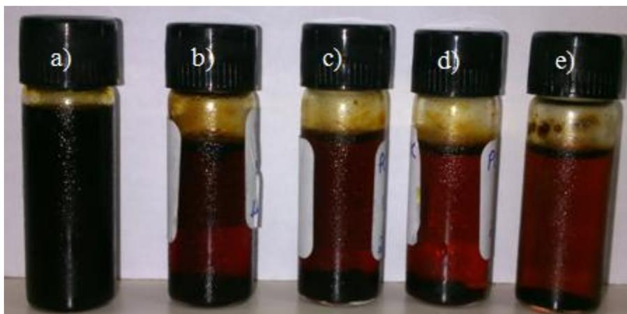
**Figura 4.12.** Amostras de bio-óleo produzidas por: a) pirólise térmica; e a pirólise catalítica usando os catalisadores: b) SnO<sub>2</sub>, c) SO<sub>4</sub>/SnO<sub>2</sub>\_1x, d) SO<sub>4</sub>/SnO<sub>2</sub>\_2x e e) SO<sub>4</sub>/SnO<sub>2</sub>\_3x.
