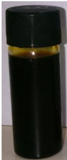
**Figura 4.5.** Amostra de Bio-óleo obtido por pirólise, a 500 °C, do bagaço de cana-de-açúcar.
