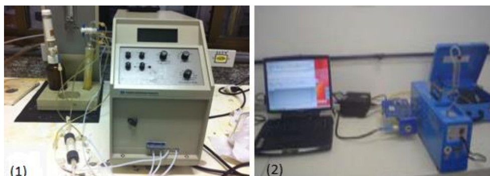
Figura 10 – (1) Espectrômetro de Absorção Atômica de Vapor Frio (CV-AAS) modelo MM 3200 da Termo Separation Products. (2) Espectrômetro de AA portátil LUMEX modelo “Mercury Analyzer RA-915+.
