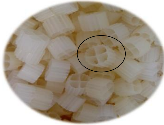
Figura 4.3: Suportes Kaldnes® K1 da utilizados no sistema MBBR.
