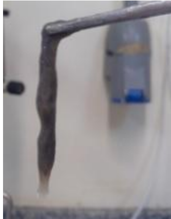
Figura 5.15: Polissacarídeos formados no reator anóxico.
