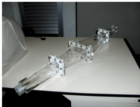
Figura 3.4: Célula de coalescência em acrílico. Retirado de COELHO [6]
