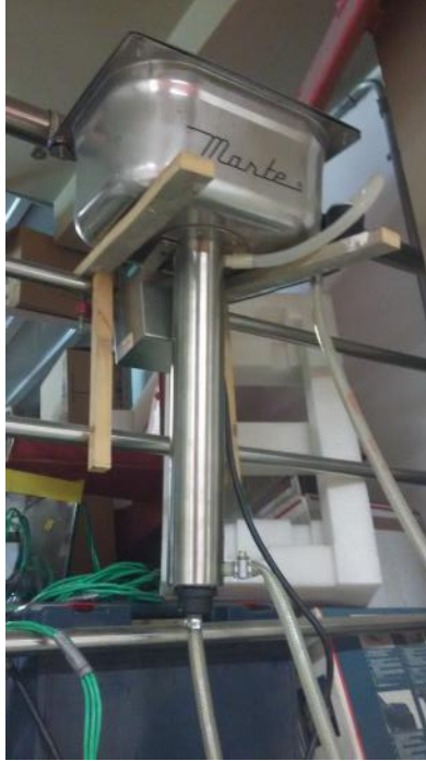
Figura 3.6: Destilador de água utilizado
