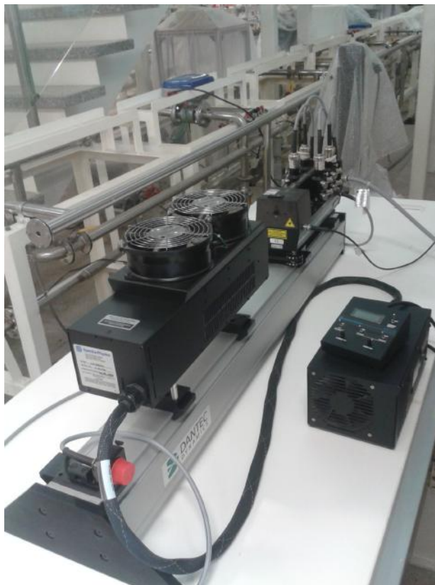
Figura 3.8: Sistema LDA utilizado nos experimentos
