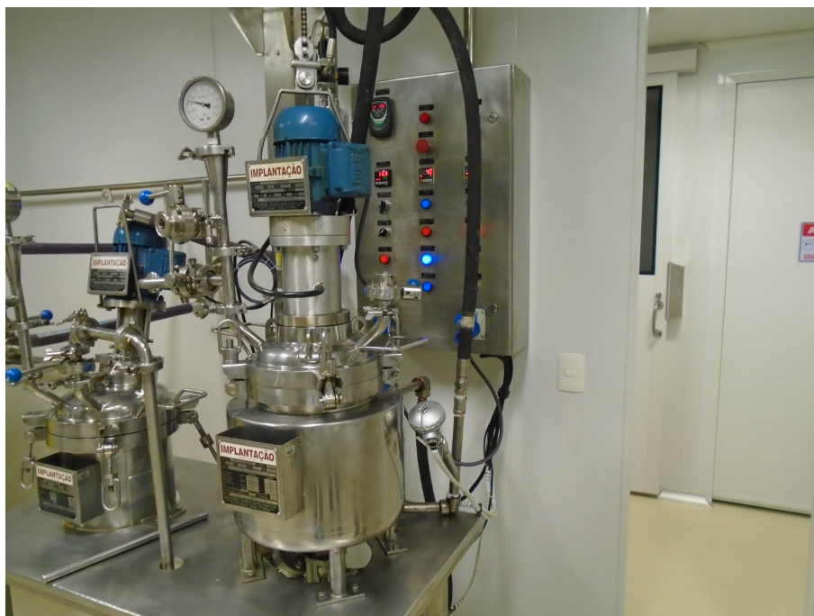
Figura 5.1: Reator utilizado no processo de polimerização em suspensão do MMA.
