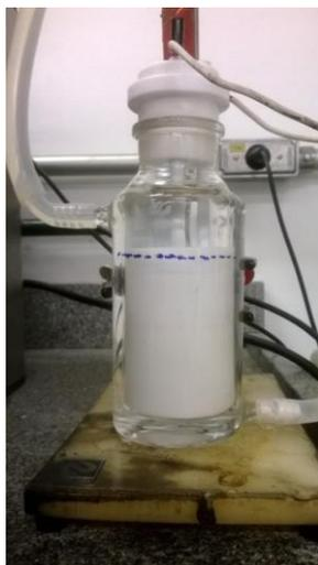
**Figura 38: Imagem da Emulsão Modelo A ao final do processo de separação eletrostática.**
