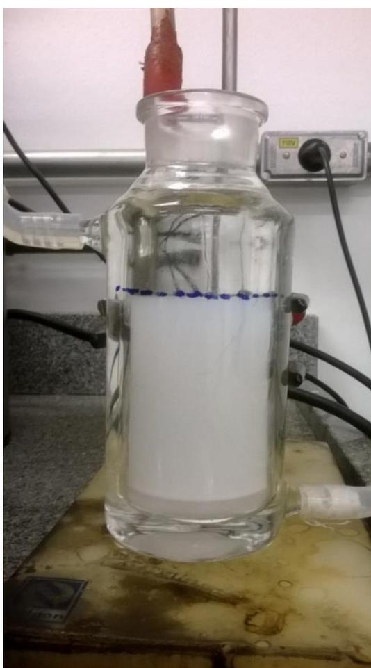
**Figura 40: Imagem do sistema formado pela Emulsão B, ao final do processo de separação eletrostática, referente à Condição 1.**
