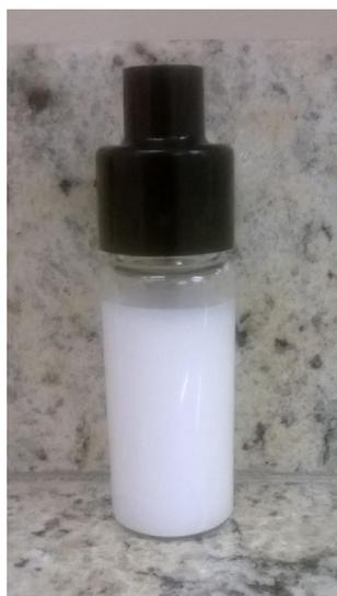
**Figura 27: Imagem da Emulsão A na cubeta utilizada para avaliação do *backscattering* da amostra.**
