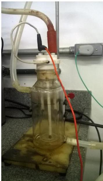
**Figura 21: Frasco de vidro encamisado acoplado ao amplificador de potência.**
