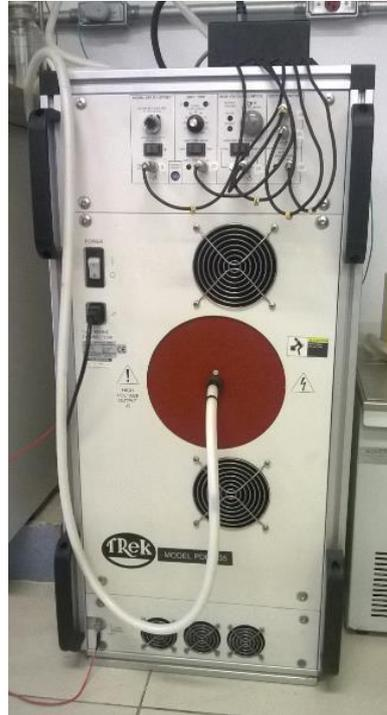
**Figura 20: Amplificador de potência PD06035.**
