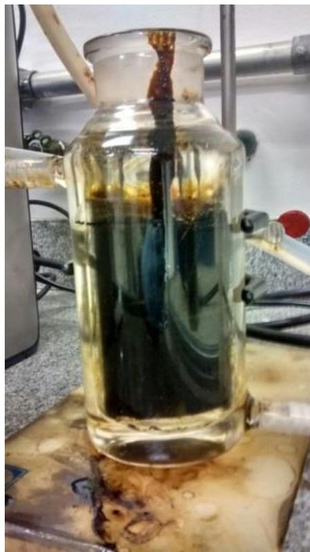
**Figura 50: Imagem do sistema formado pela Emulsão P Salina ao final do processo de separação eletrostática, referente à Condição 12.**
