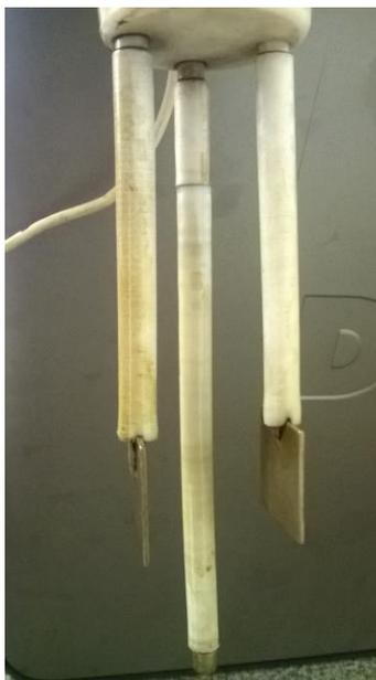
**Figura 22: Conjunto de eletrodos do sistema de eletrocoalescência.**
