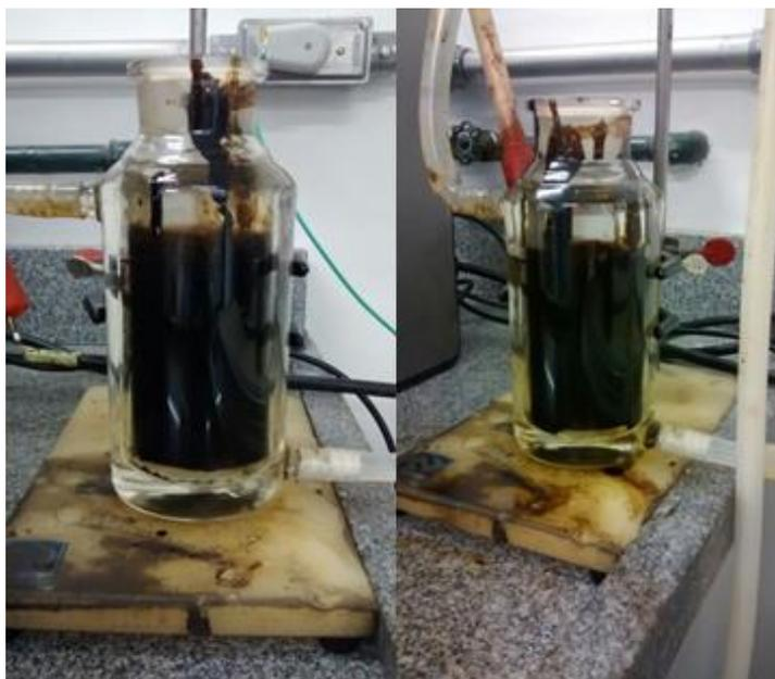
**Figura 47: Imagem do sistema formado pela Emulsão P Deionizada ao final do processo de separação eletrostática, referentes às Condição 12 e 4. As demais condições seguem a mesma tendência.**
