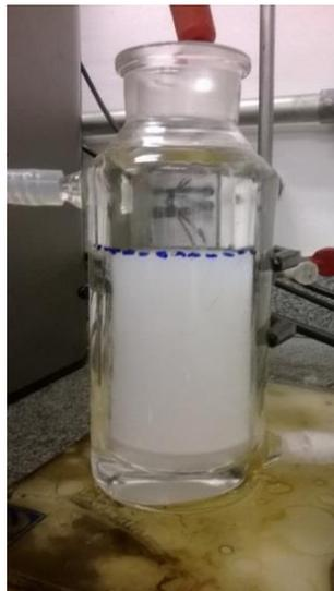
**Figura 44: Imagem do sistema formado pela Emulsão C ao final do processo de separação eletrostática, referente à Condição 7. As demais condições seguem a mesma tendência.**
