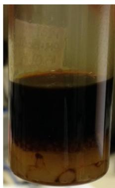
Figura 4.49: Fração líquida obtida a partir do processo de co-pirólise térmica.
