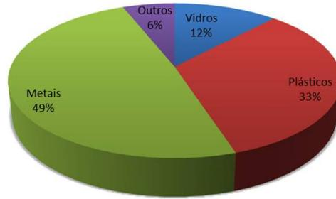
Figura 1.1: Composição dos Resíduos de Equipamentos Elétricos e Eletrônicos (RE-EEs). Adaptado de KANG e SCHOENUNG (2005)
