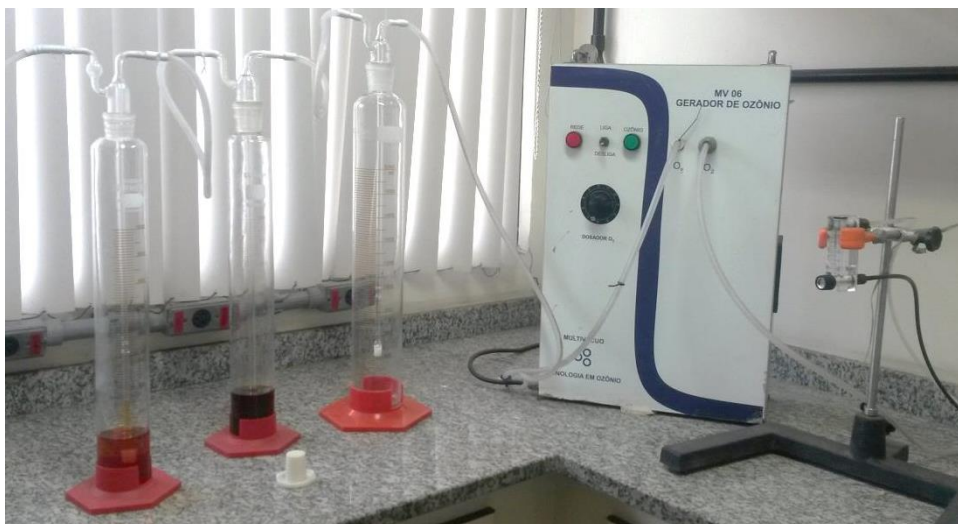
Figura 27 - Configuração experimental da ozonização
