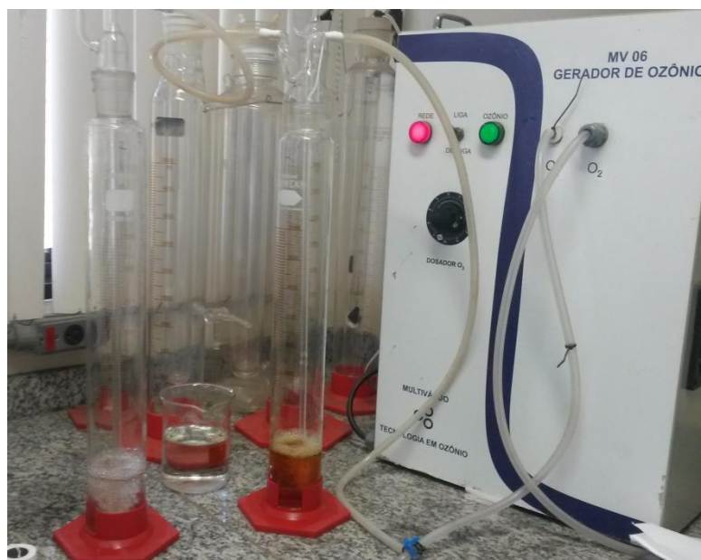
Figura 28 - Aparato utilizado para a calibração do gerador de ozônio
