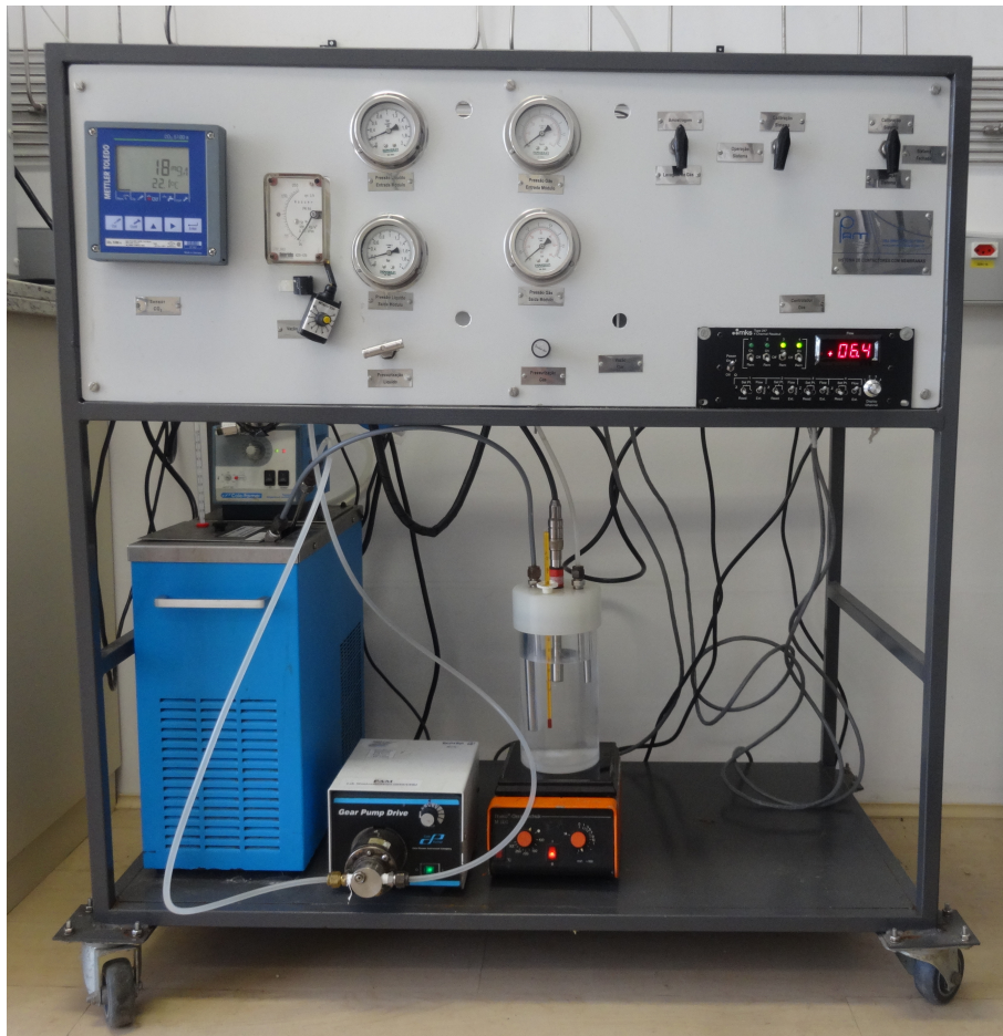
Figura 3.7: Sistema de contactores com membranas
