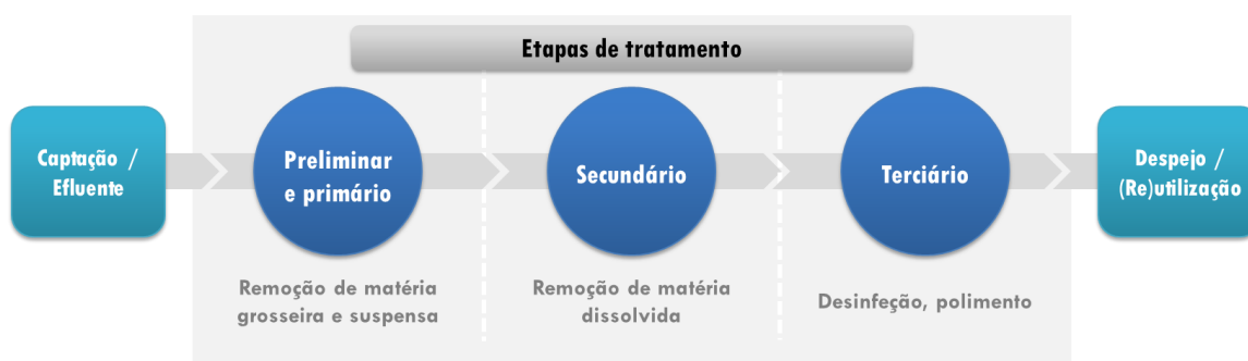
Figura 2.2: Esquema de macroprocessos envolvidos no tratamento de águas.
