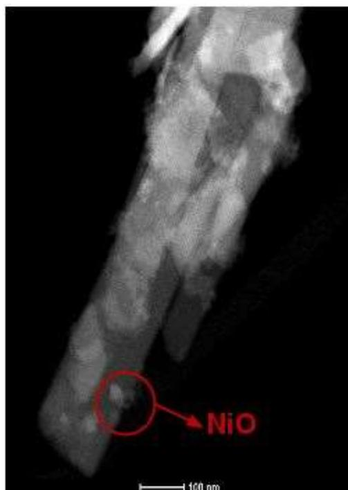
Figura 4.5 – Micrografia de MET para a amostra Ni/MoO<sub>3</sub>-N.
