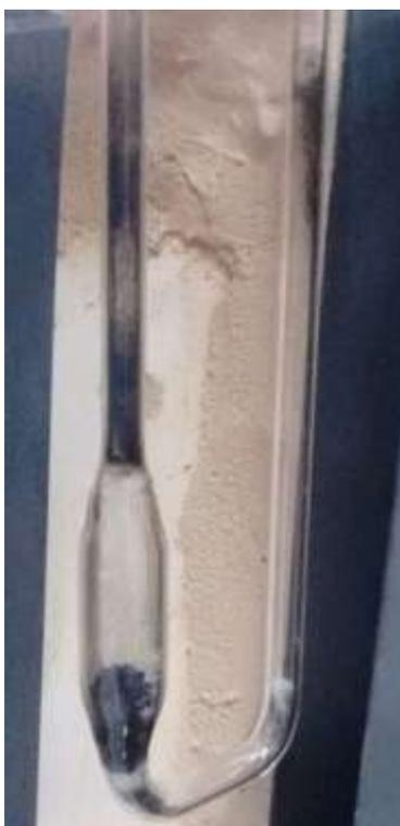
Figura 4.18 – Reator entupido devido à formação de carbono filamental decorrente da decomposição do CH<sub>4</sub> no catalisador de Ni-C.
