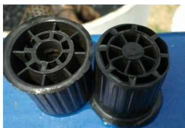
Figura 3.1: Mídia MOD940, da AMBIO Engenharia LTDA, já com biofilme desenvolvido em sua área interna. Fonte: Arquivo Pessoal.
