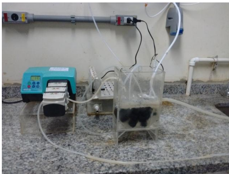
Figura 3.7: Vista frontal do reator de bancada em operação, alimentado por bomba dosadora. Fonte: Arquivo Pessoal
