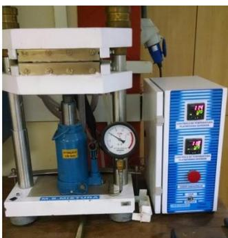
**Figura 3.8.** Prensa utilizada para moldagem das amostras
