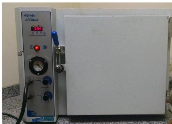
**Figura 3.6.** Estufa utilizada em parte das reações de polimerização.
