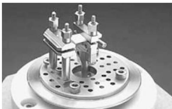
**Figura 3.11.** Sistema de fixação unilateral utilizado no DMA.
