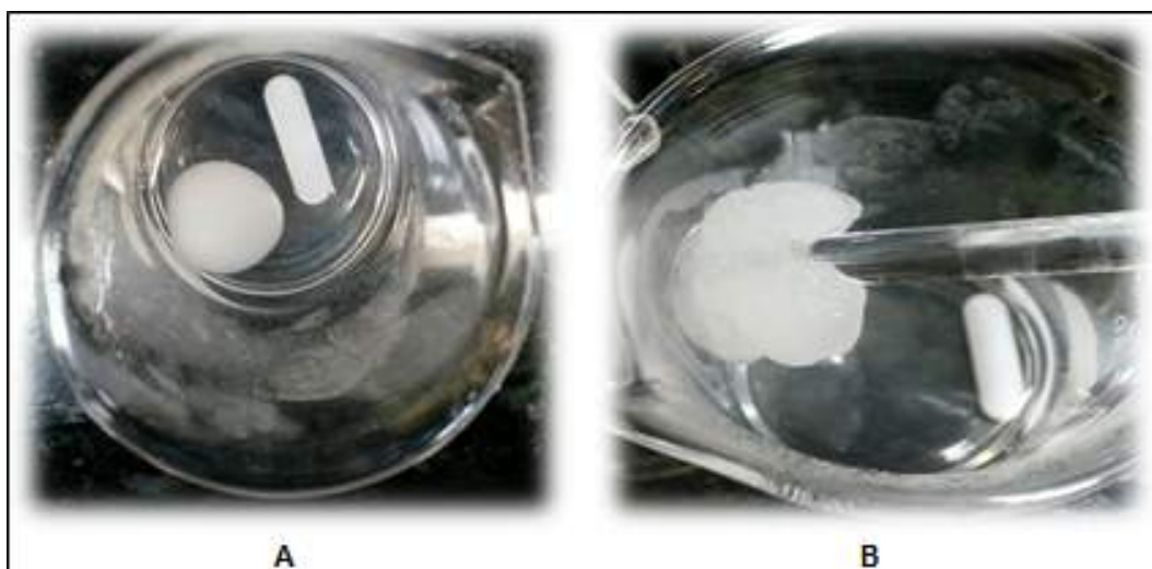
Figura 4.10: Reticulação do PVA com o ácido bórico a 80 °C - (A) 3% PVA e 1,5% ácido bórico e (B) 3% PVA e 2% ácido bórico.
