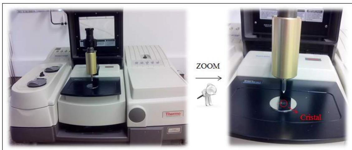
Figura 3.4: Espectrômetro de FTIR com acessório de ATR.
