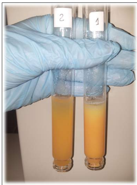
Figura 4.62: Tubo de ensaio obstruído pelo PVA reticulado com o persulfato.
