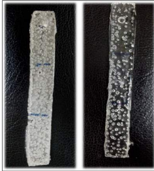
Figura 4.57: Corpo de prova com composição de 6% de PVA, 30% de ácido acrílico e 0,8% de persulfato de potássio.
