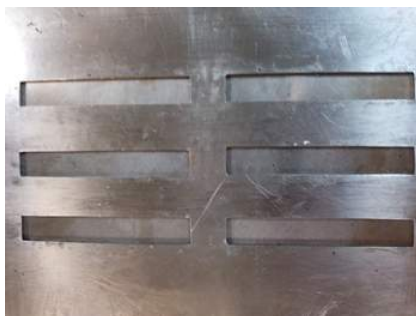
Figura 3.6: Placa molde usada para a confecção dos corpos de prova para os testes de tração.
