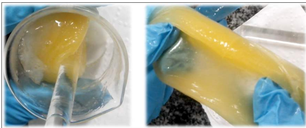
Figura 4.13: Gel reticulado preparado a 70 °C, partindo da concentração 7,6% PVA e 4,6% persulfato de potássio.
