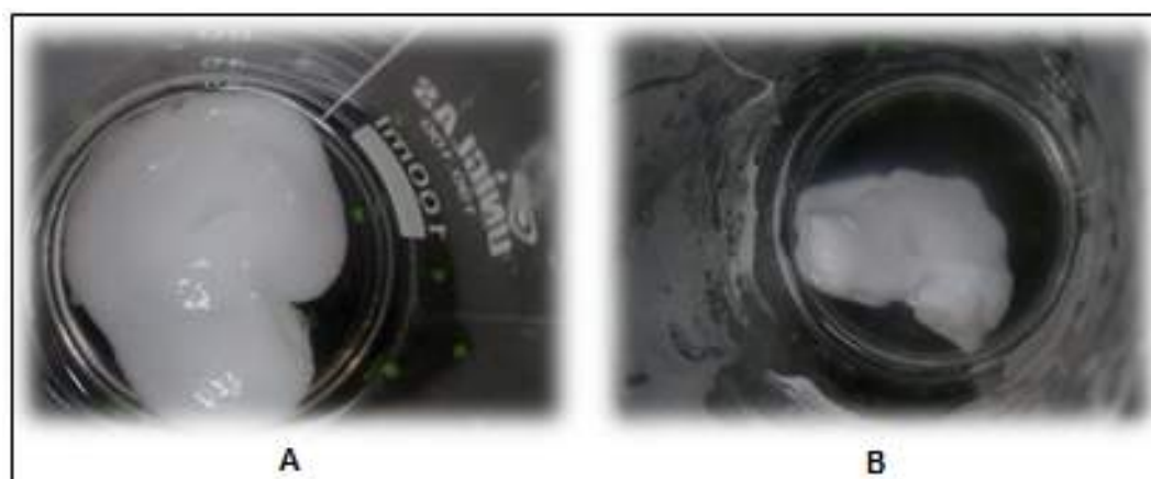
Figura 4.11: Reticulação do PVA com o ácido bórico a 80 °C - (A) 6% PVA e 2% ácido bórico e (B) 6% PVA e 3,5% ácido bórico.
