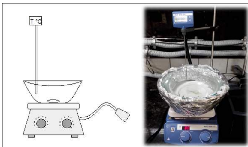
Figura 3.8: Aparato experimental usado para preparo da solução usada nos testes em tubo de ensaio.
