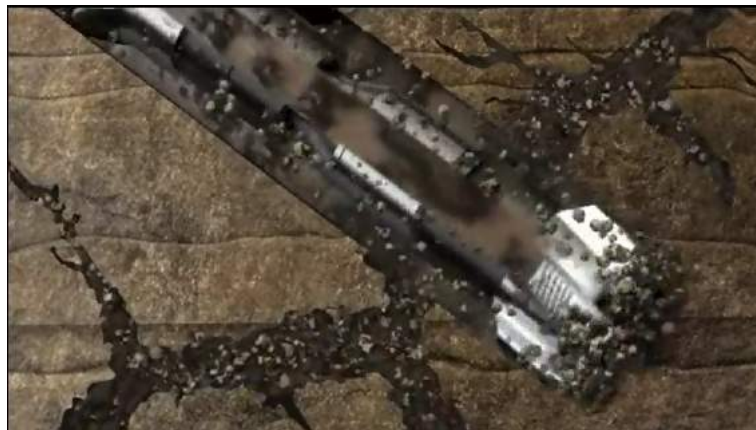
Figura 2.2: Perda de circulação em uma formação rochosa cavernosa. Adaptado de HALLIBURTON.
