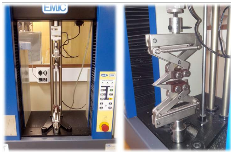
Figura 3.5: Equipamento EMIC usado nos teste de tração.
