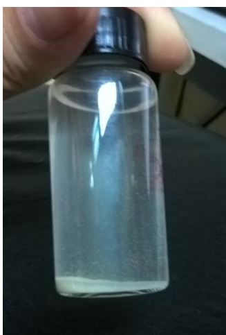
Figura 4.11 – Aspecto do efluente coletado durante teste com \text{Fe}_2\text{P}/\text{SiO}_2 imediatamente após o término do experimento (WHSV 15 \text{ h}^{-1} , 30 bar, 125 \text{ }^\circ\text{C} ).
