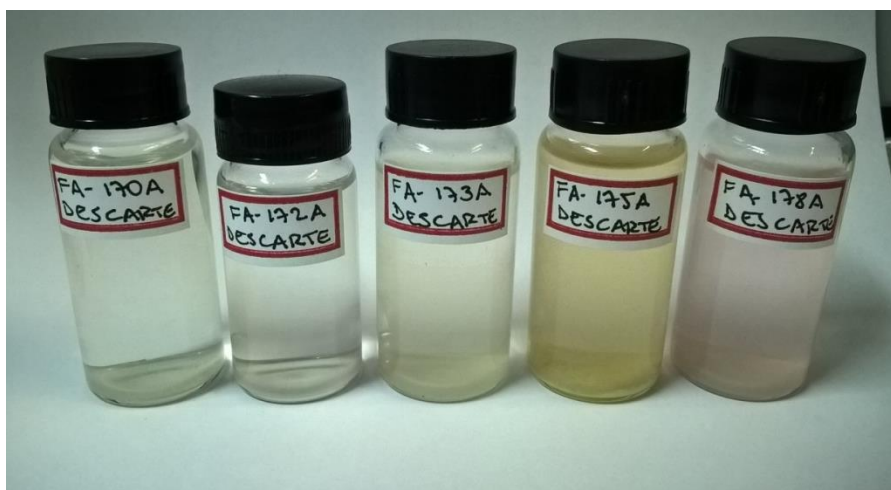
Figura 4.12 – Aspecto dos efluentes obtidos durante testes catalíticos empregando-se, da esquerda para a direita, fosfeto de Ni, Mo, W, Fe e Co suportado em sílica.
