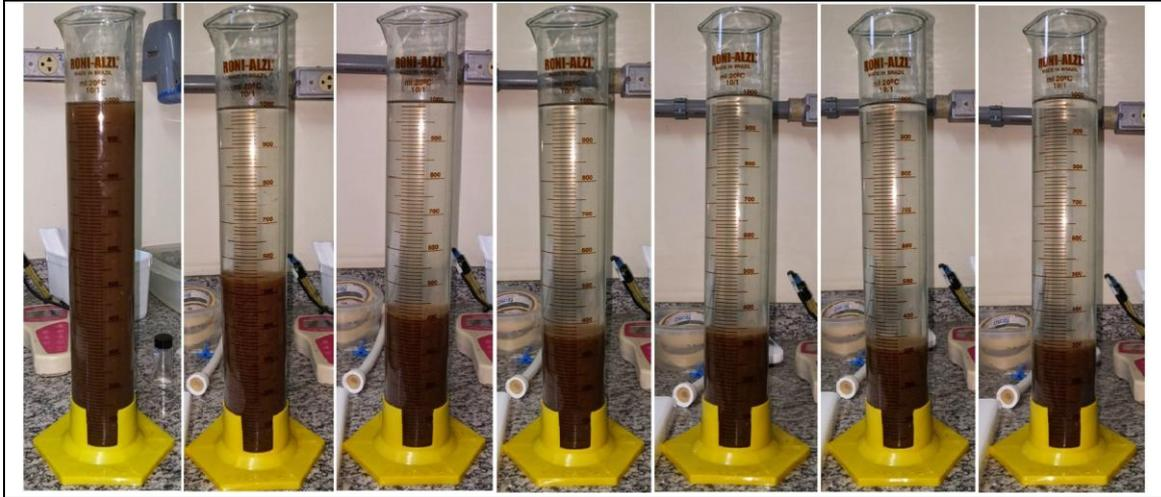
**Figura 5.18: Evolução da sedimentação durante o teste de IVL (fotos tiradas a cada 5 min) realizado antes da aplicação dos choques.**
