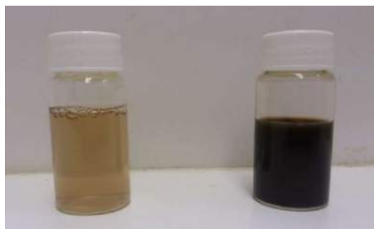
Figura 19 - Suspensões de NPM em solução de lauril sulfato de sódio a 3,0 % p/p (esquerda) e citrato de sódio a 0,3 % p/p (direita). Amostras foram filtradas em membrana de 0,25 \mu\text{m} , após 2 h de agitação mecânica.
