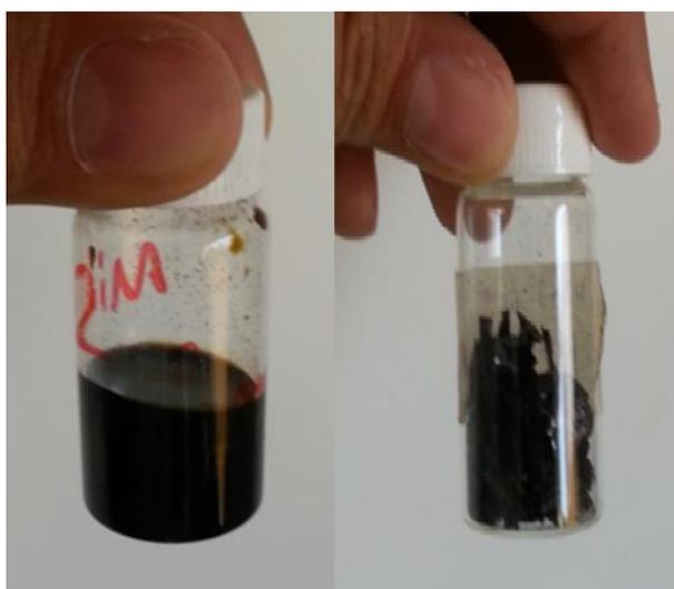
*Figura 40. Fração líquida (à esquerda) e fração sólida (à direita) obtida após pirólise do PVC Puro.*
