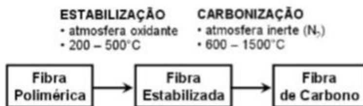
Figura 2.9 - Representação esquemática do processo de obtenção de membranas de carbono (BARBOSA-COUTINHO, 2004).
