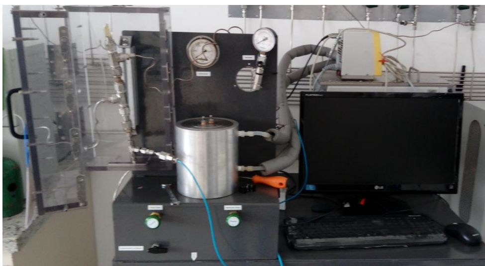
Figura 3.4 - Sistema de permeação a gases puros para membranas de carbono.
