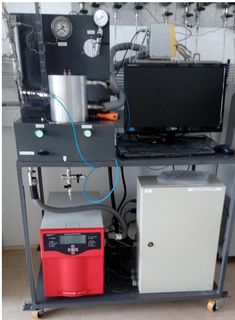
Figura 3.5 - Sistema de permeação de mistura para membranas de carbono.
