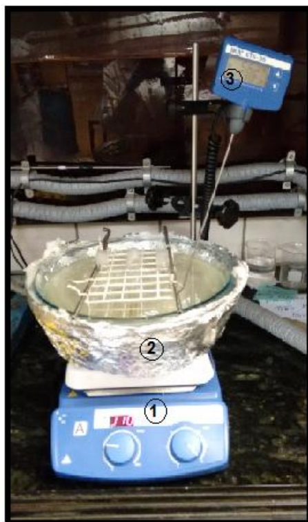
Figura 14 - Unidade experimental utilizada para a síntese de PVP e dos copolímeros.
