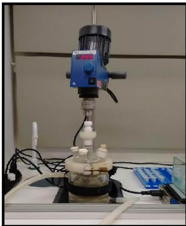
Figura 17 - Unidade experimental utilizada para obtenção de PVP para caracterização.
