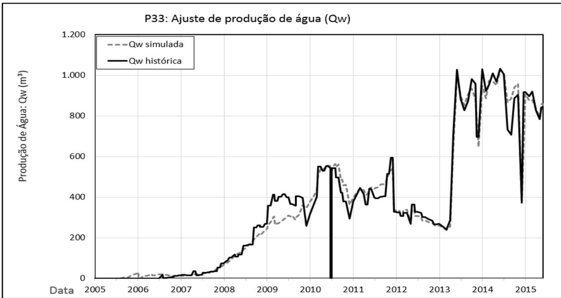
Figura 8: Ajuste de produção de água do poço 33. A curva cheia preta representa as vazões de produção de água históricas do poço (Qw histórica) e a curva tracejada em cinza representa os valores obtidos no modelo de fluxo do campo (Qw simulada).
