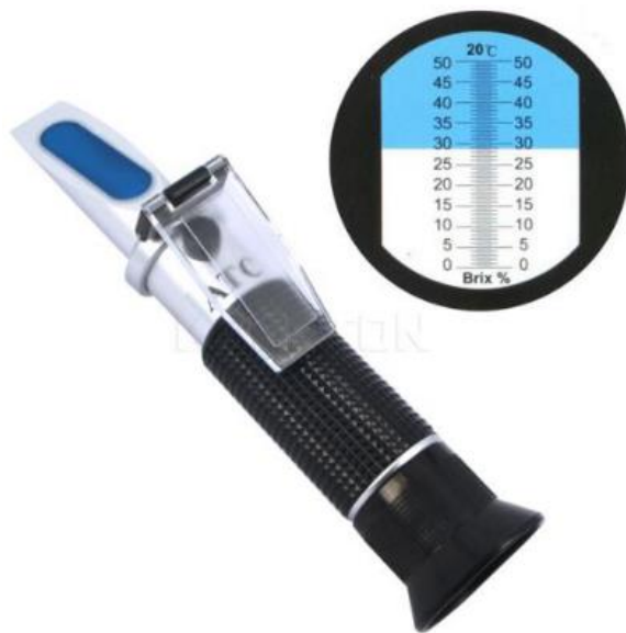
Figura 14. Refratômetro portátil e escala de medição para leitura do grau brix utilizado nos experimentos.
