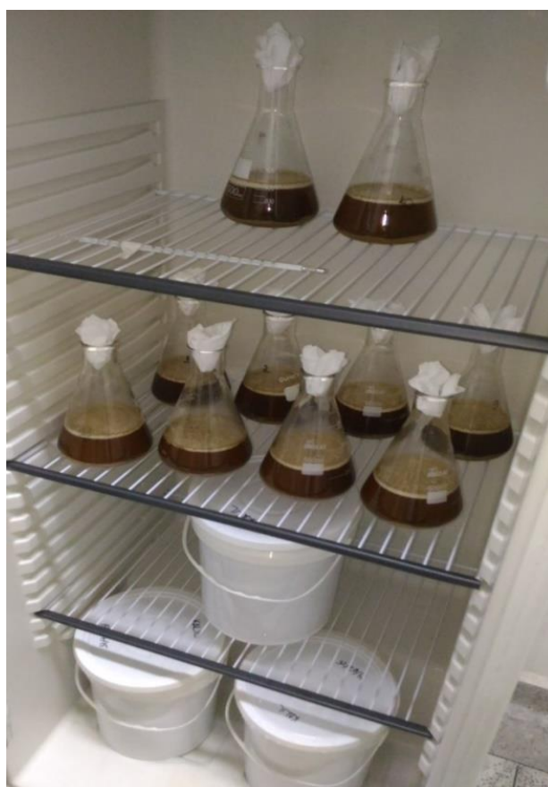
Figura 13. Fotografia da etapa de maturação pós-fermentação conduzida na geladeira acoplada a um controlador de temperatura.
