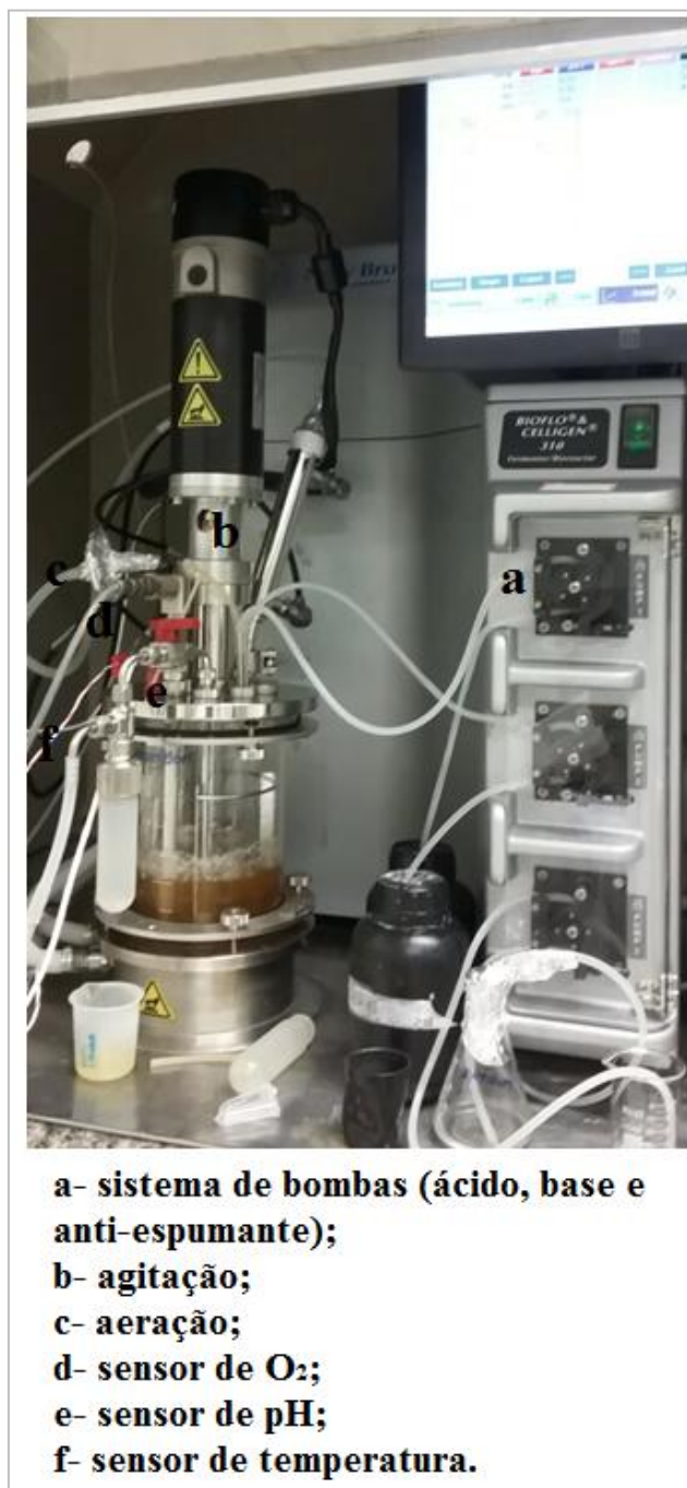
Figura 8: Batelada convencional, conduzida no biorreator da BIOFLO® & CELLIGEN® 310, para a produção de 2,3-BDO.
