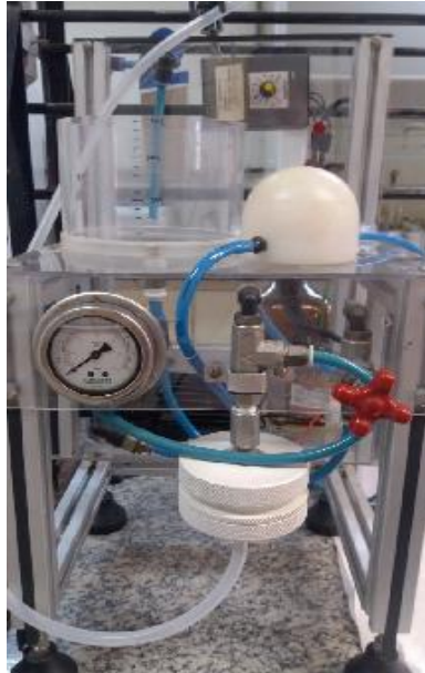
Figura 13. Sistema de MF pressurizada de bancada.
