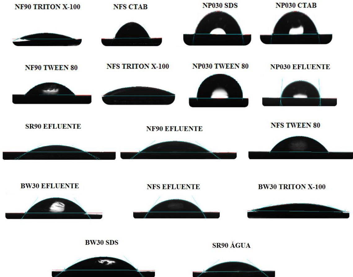
Figura B. Medições de ângulo de contato com diferentes membranas utilizando soluções individuais de surfactantes.
