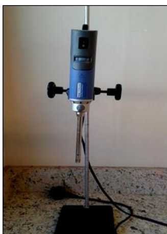
Figura 14 - Ultra-turrax (IKA, modelo T-10 basic) usado para homogeneização da 1E e 2E.
