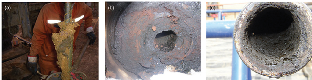
Figura 1.1: Precipitação de Parafinas. Fonte: www.spe.org/jpt
