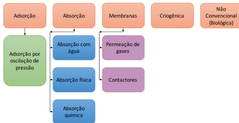
Figura 2 – Esquema dos processos de remoção de dióxido de carbono existentes (Adaptado de WARREN, 2012)
