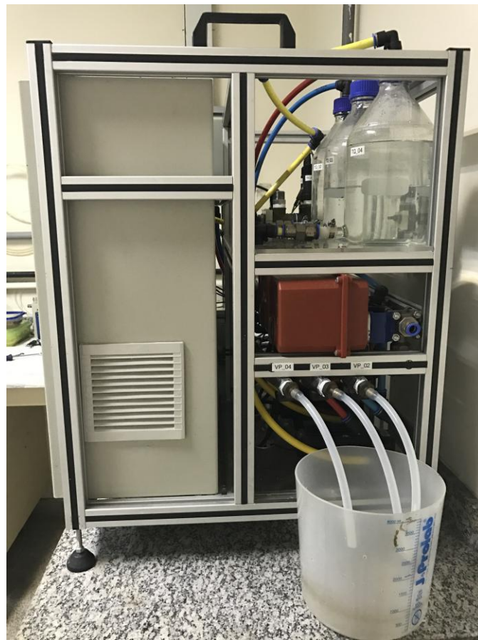
Figura 22 – Vista lateral do sistema de eletrodiálise
