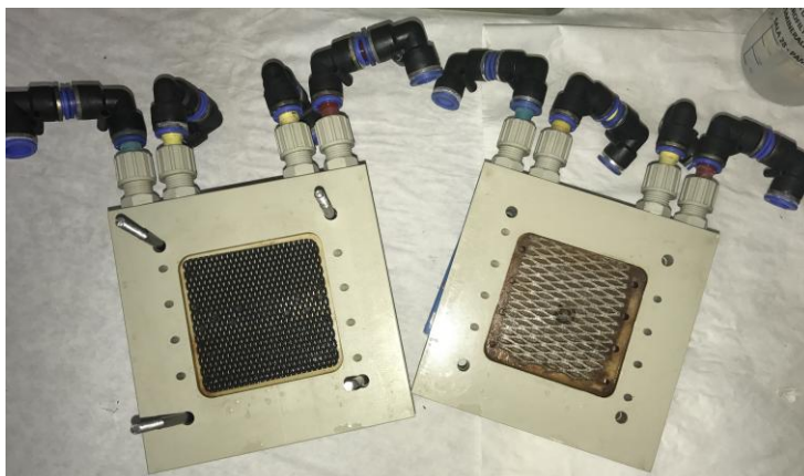
Figura 20 – Vista interna da célula contendo seus respectivos eletrodos (catodo e anodo).
