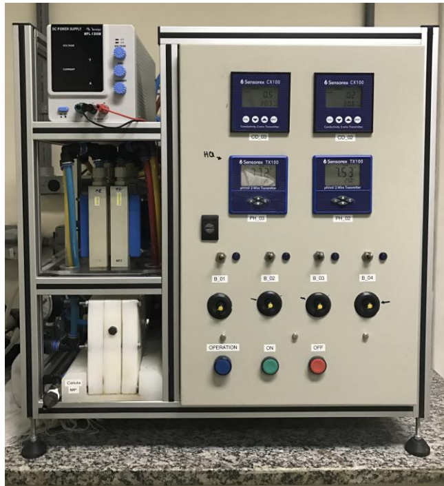
Figura 21 – Vista frontal do sistema de eletrodiálise
