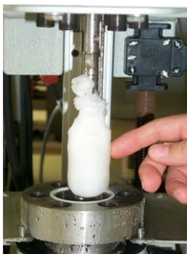
Figura 2.1: Bloco de hidratos formado em laboratório do CENPES. Retirado de Valim (2015).
