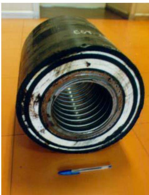
Figura 2.10: Exemplo de linha flexível isolada utilizada em campos da PETROBRAS (Retirado de Valim (2015)).
