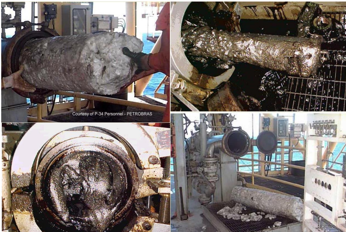
Figura 2.4: Exemplos de bloqueios por hidratos. Retirado de Valim (2015).
