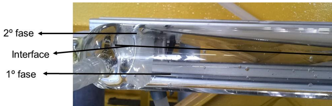
Figura 7.9: Dinâmica da misturação do EtOH com a água para o experimento 8.
