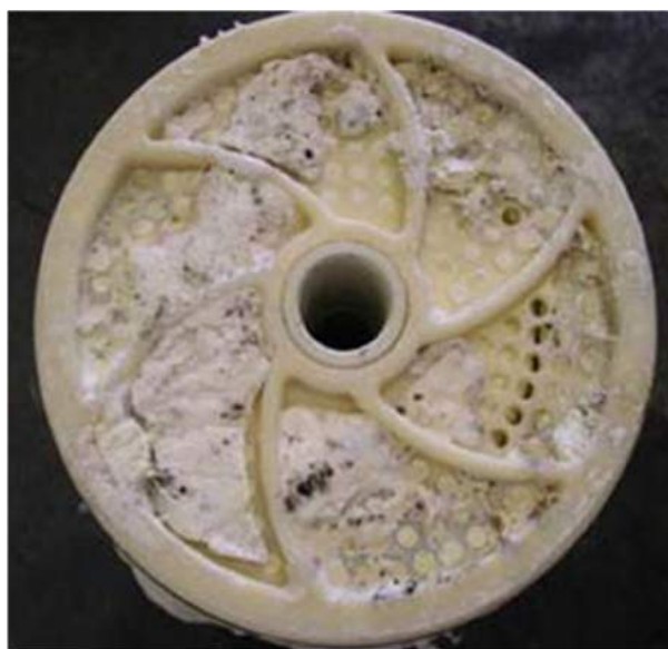
Figura 21 - Membrana com incrustação inorgânica ( scaling ) (LENNTECH, 2018).
