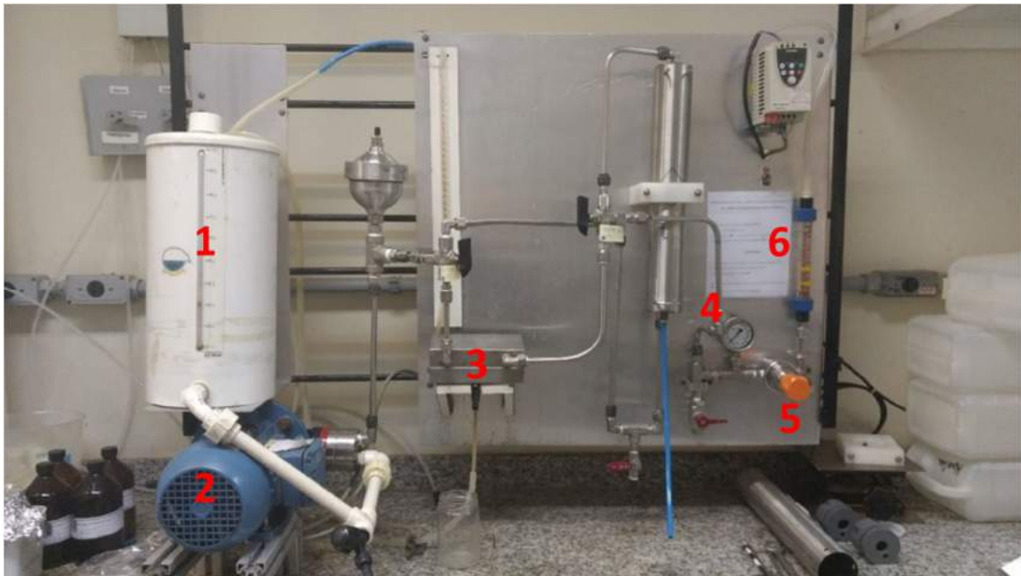
Figura 40 – Foto do sistema utilizado para a determinação da permeabilidade hidráulica: 1 – tanque; 2 – bomba; 3 – célula metálica com membrana; 4 – manômetro; 5 – válvula de ajuste e 6 – rotâmetro.
