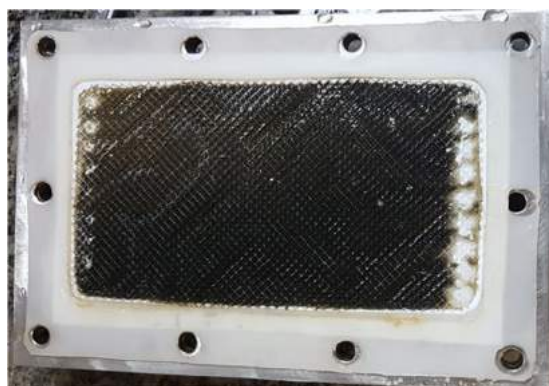
Figura 49 - Foto da membrana incrustada com água de filtração convencional.
