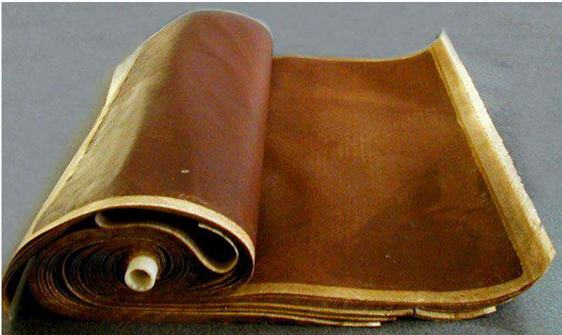
Figura 20 - Membrana com incrustação orgânica (FRAVEL JR.; LINDSEY, 2014).
