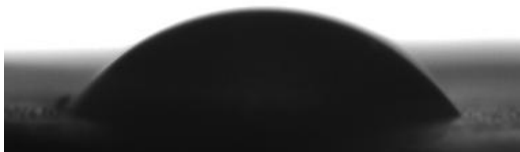
Figura 4.2: Imagem do ângulo de contato da água ultrapura sobre a membrana de microfiltração.
