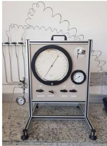
Figura 3.7: Equipamento utilizado no preparo da mistura de gases.
