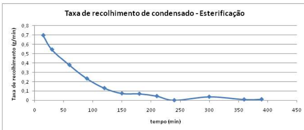
Figura B.5: Recolhimento de condensado na reação do poliol 2 na esterificação.
