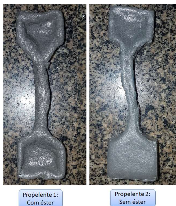
Figura 6.7: Propelentes à base de PBES 7 da Fase 3 após 7 dias de cura nos moldes.
