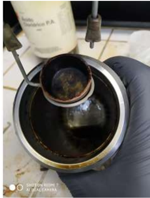
Figura 6.3: Preparação do teste de queima e produto final queimado na amostra 6 da Fase 3.
