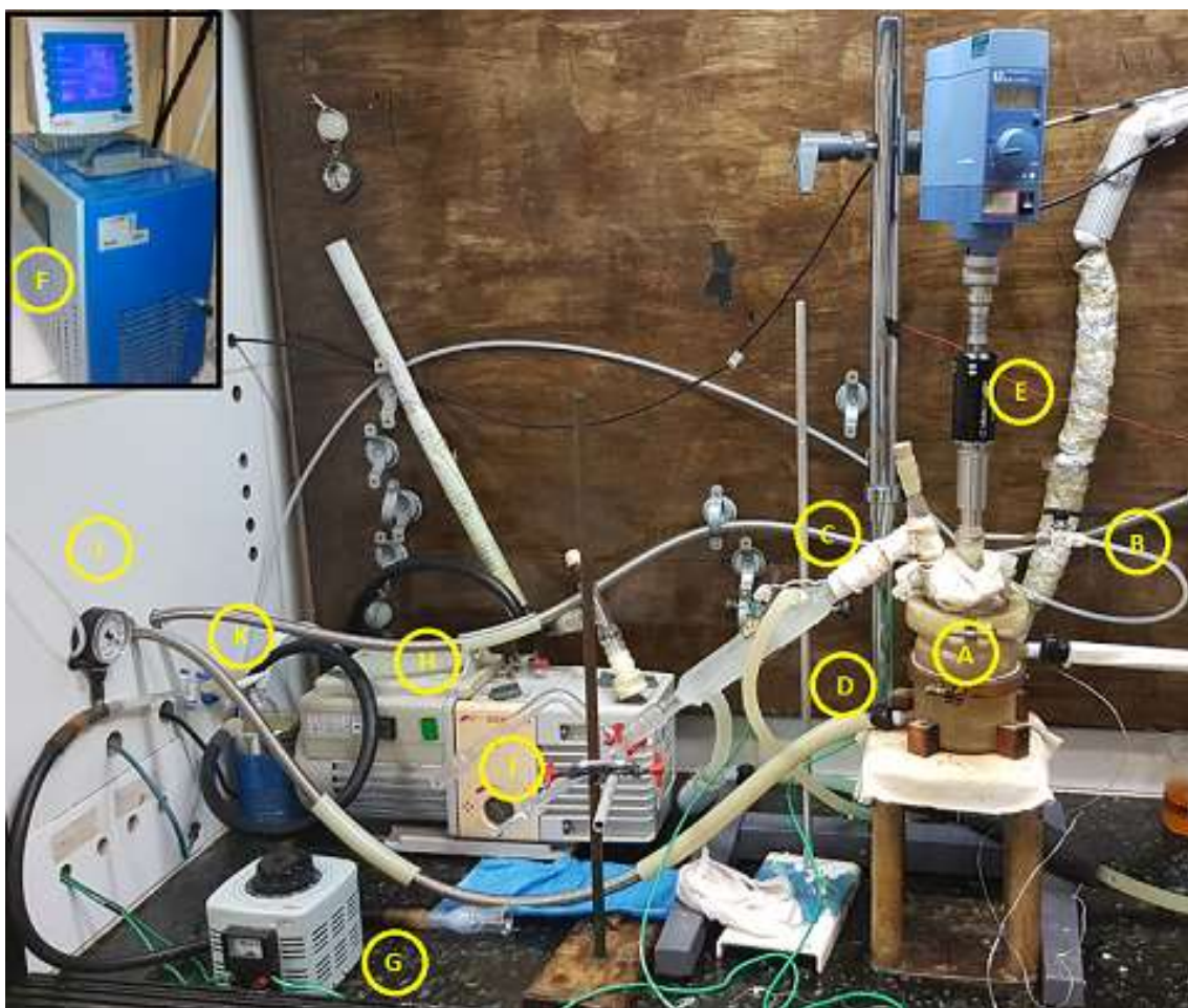
Figura 3.7: Unidade experimental usada na Fase 1 - (A) reator; (B) alimentação de nitrogênio; (C) condensador; (D) mangueira do banho; (E) agitador mecânico; (F) banho termostático; (G) variac; (H) bomba de vácuo; (I) Dean Stark; (J) pressostato; (K) trap.
