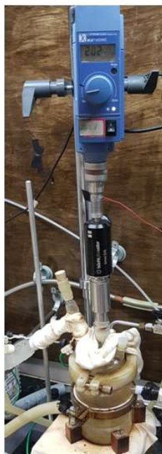
Figura 4.3: Reator de polimerização usado na Fase 1 do trabalho.
