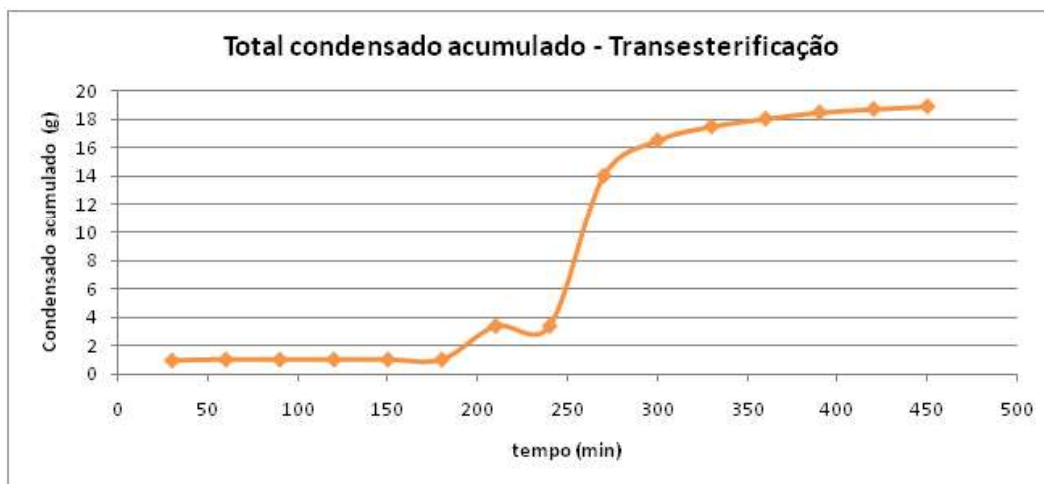
Figura B.4: Total de condensado recolhido na reação do poliol 1 na transesterificação.
