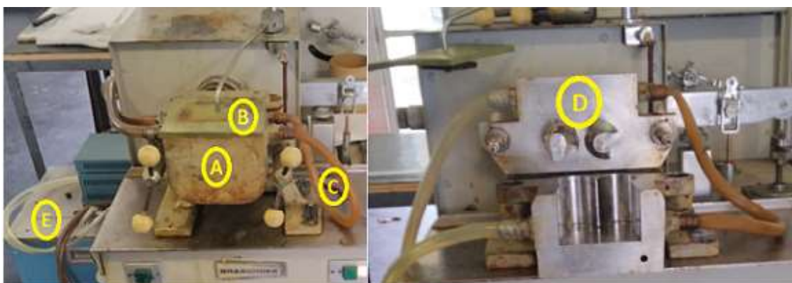
Figura 3.9: Unidade experimental para a Fase 3 - (A) farinógrafo; (B) tampa; (C) mangueira do banho; (D) eixo de agitação; (E) banho termostático.
