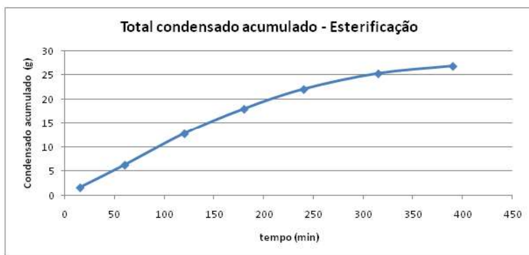
Figura B.18: Total de condensado recolhido na reação do poliol 5 na esterificação.
