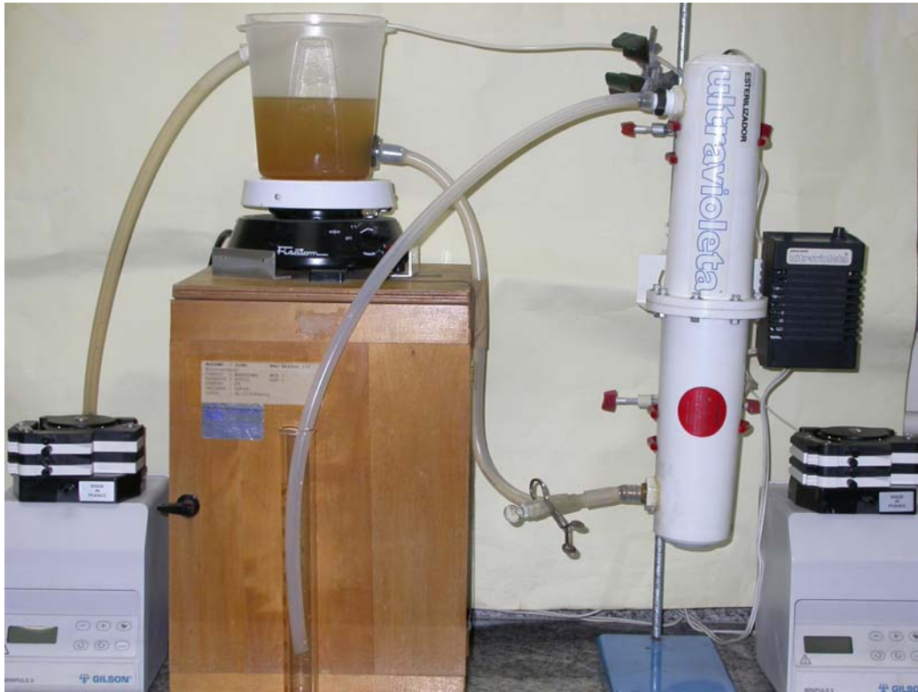
Figura 4.7 – Foto do sistema reacional 3 operado continuamente – Processos Fenton e foto-Fenton
