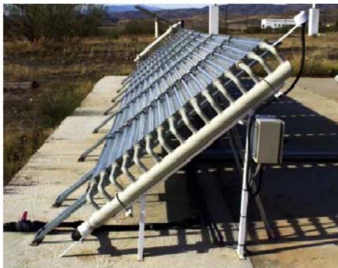
Figura 2.4 – Foto do reator solar parabólico em escala industrial
