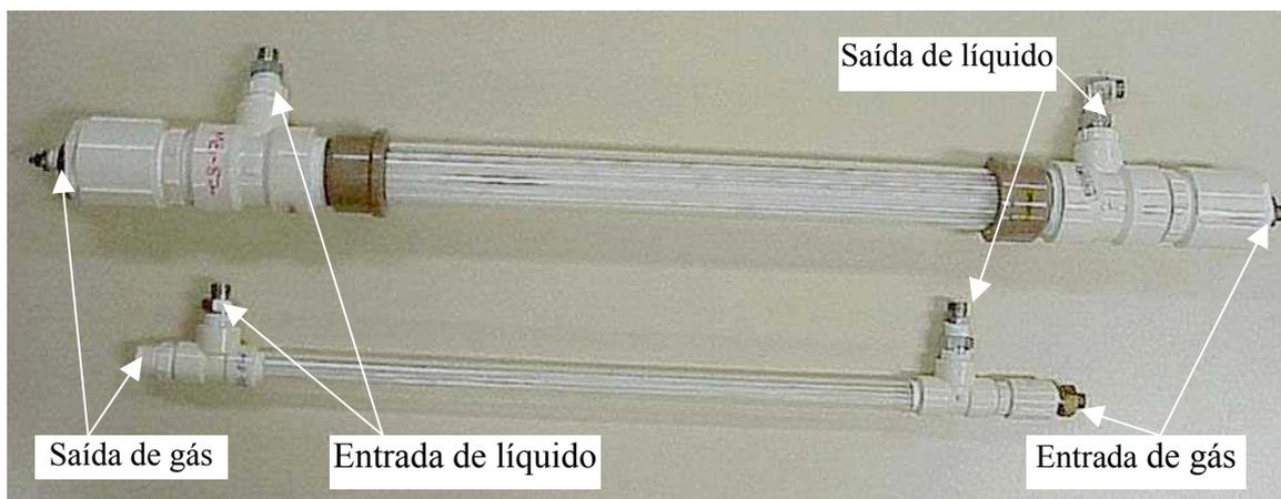
Figura III.1 - Módulos M8-18 e M8-87 construídos para o desenvolvimento do trabalho.
