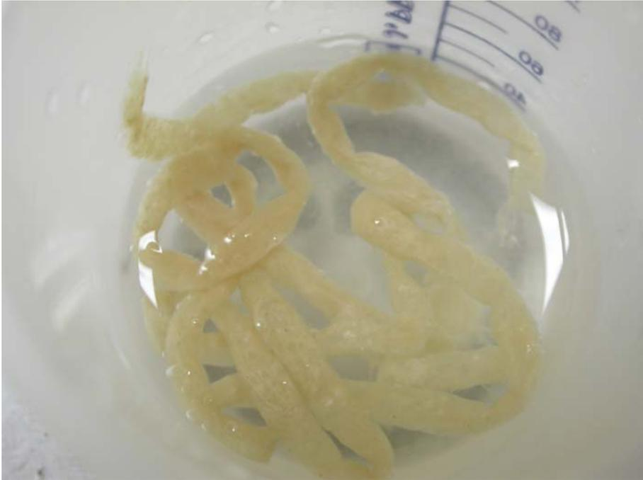
Figura IV.34 - Biofilme retirado das mangueiras de sucção e de descarga da bomba de reciclo.
