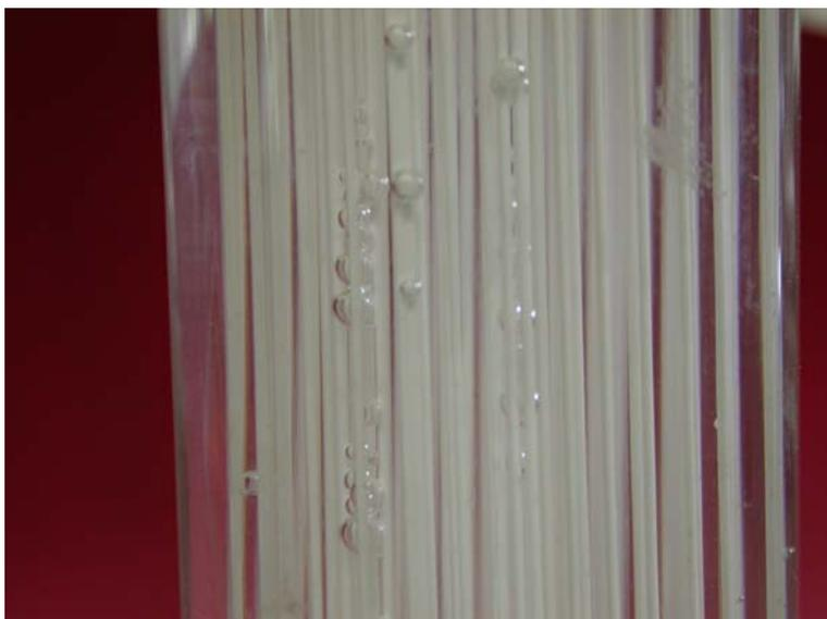
Figura IV.13 – Detalhe da formação de bolhas na superfície da membrana M8.
