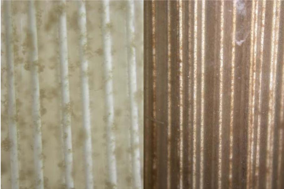
Figura IV.30 - Imagens das fibras mostrando o crescimento do biofilme após o 5 e o 8 dia do início da operação.
