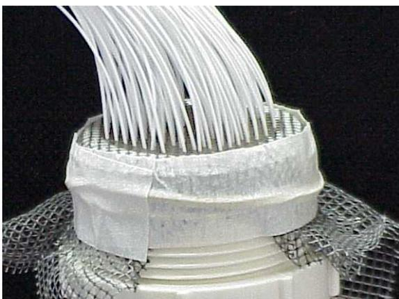
Figura III.2 - Colagem das fibras em Niple de 1" de PVC .
