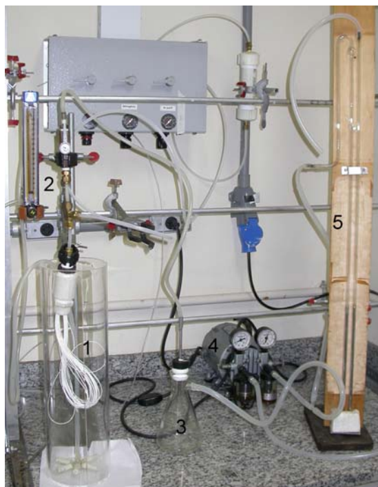
Figura 3-4 – Fotografia do aparato experimental utilizado nos experimentos do ciclo de permeação/retrolavagem.
