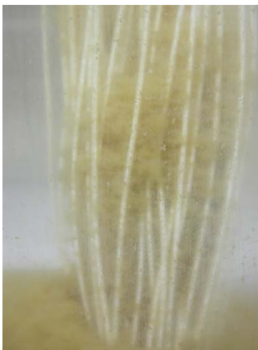
Figura 4-21 – Fotografia do feixe de membranas no biorreator após ligeira sedimentação da biomassa, durante o período de teste do uso de relaxação.
