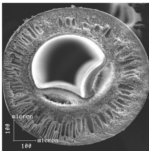
Figura 4-6 – Seção transversal da membrana de PEI selecionada, com aumento de 150 x.
