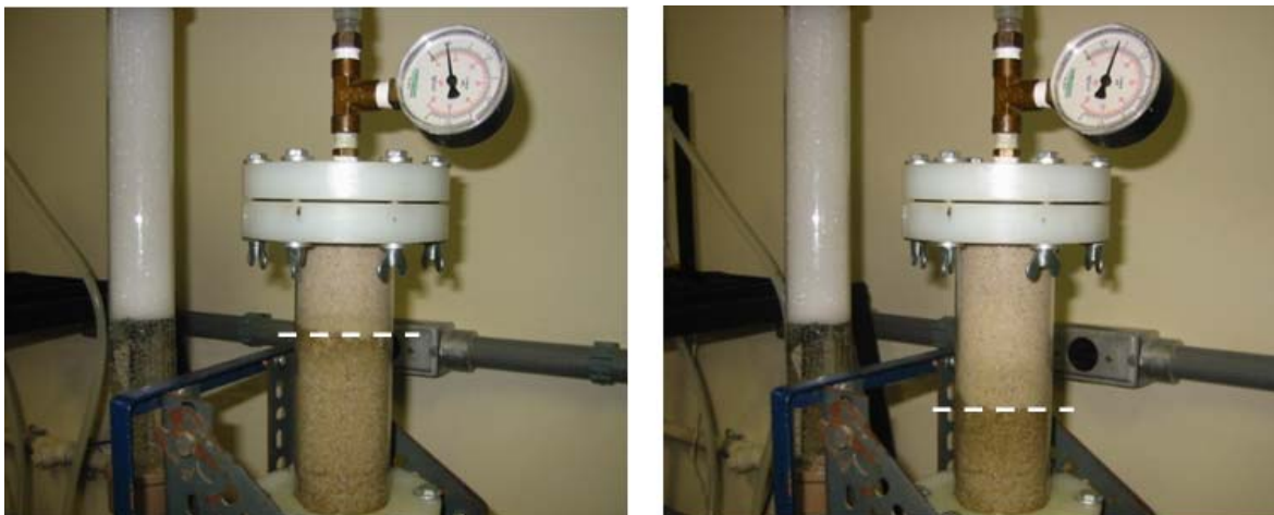
Figura 4.35: Visualização da frente de propagação das ER no meio poroso para o Experimento10 ( Q_{Ar}/Q_s = 82 , D_p = 0,08\text{cm} , C_{oi} = 60\text{g/kg} )
