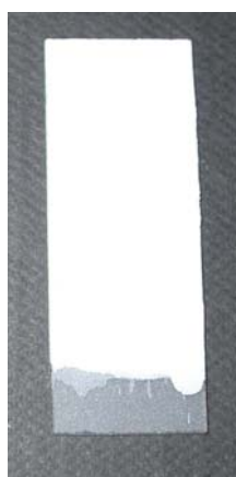
Figura 2.10: Lâmina de vidro com filme de TiO 2 preparado segundo técnica Teixeira (2002).
