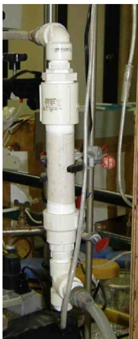
Figura 2.16: Detalhe do aerador.
