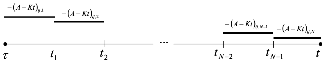
Figura (4.1) – Evolução de um elemento -(A - Kt)_{ij} da matriz -(A - Kt) com o tempo, em sua forma discretizada.
