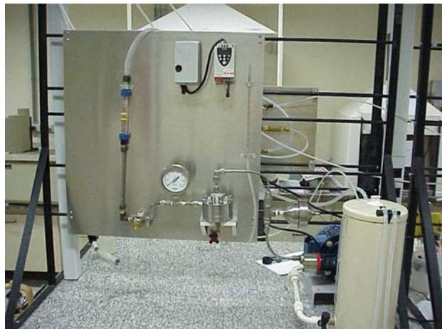
**Figura 11 - Fotografias do sistema de nanofiltração**
