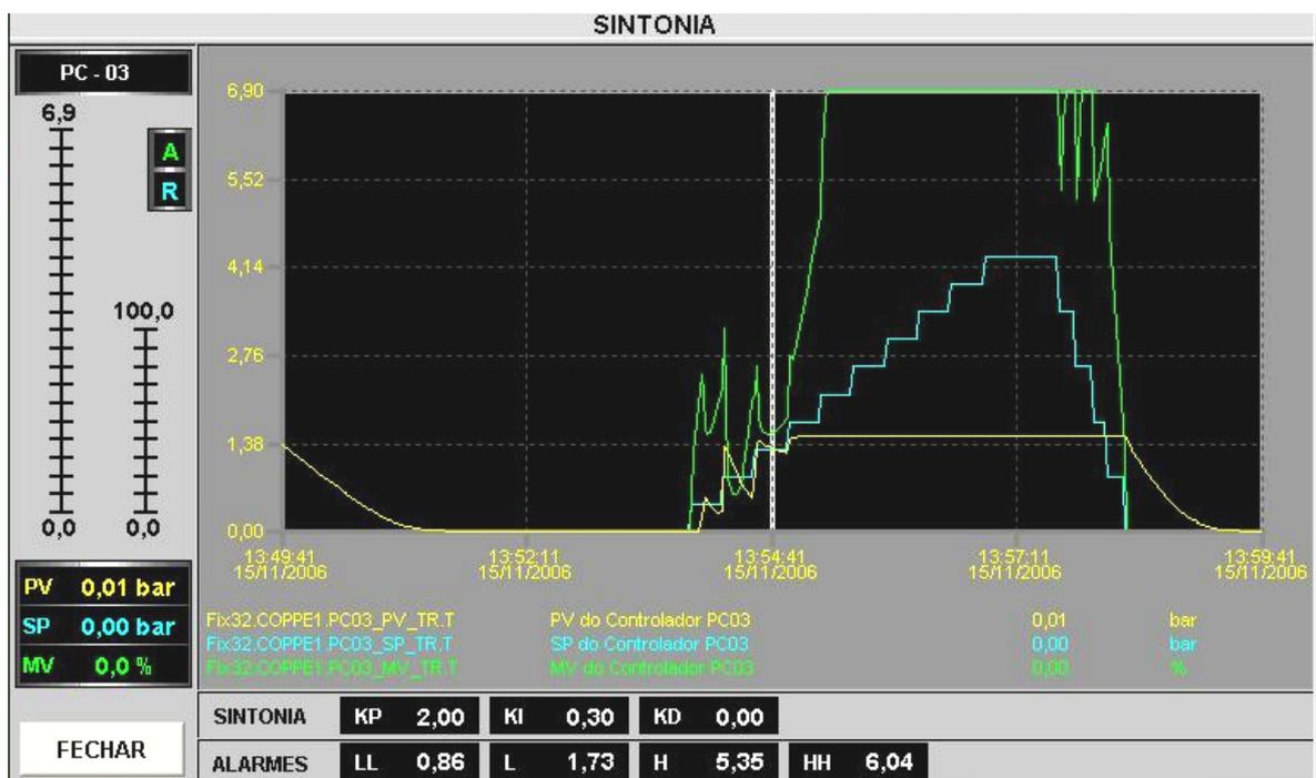
Figura 4.33: Atuação do controlador sobre a válvula de entrada (v2) para a regulação da concentração de oxigênio dissolvido. Curva azul – valor estabelecido para a pressão de gás pelo CLP; curva amarela – valor medido; curva verde – atuação sobre a válvula.
