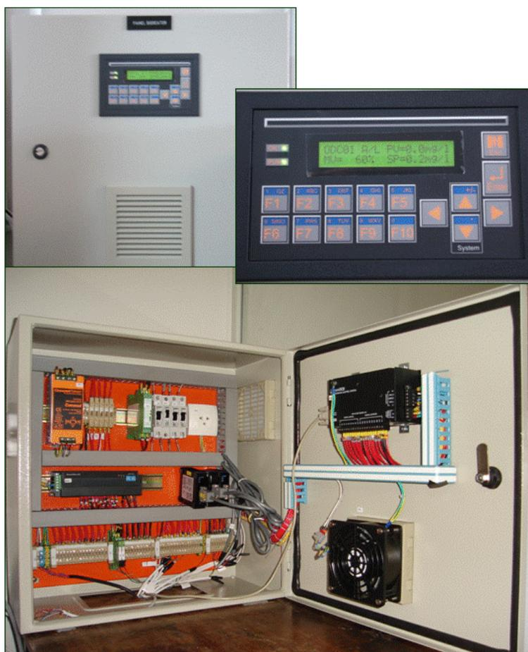
Figura 3.3: Controlador Lógico Programável utilizado para implementação de uma malha de controle da concentração de oxigênio dissolvido nas fermentações para a produção de ramnolipídeos por *Pseudomonas aeruginosa*.
