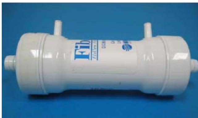
Figura 3.4: Fotografia do módulo comercial com membranas microporosas.
