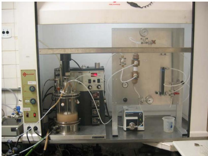
Figura 3.2: Fotografia do fermentador inserido na capela de exaustão acoplado ao sistema de oxigenação utilizando o contactor de membranas
