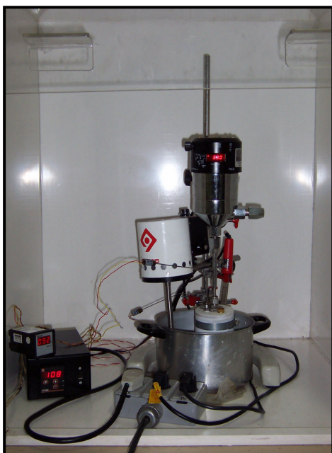
Figura 4.1. Sistema experimental empregado nos processos de dissolução das amostras.
