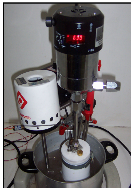
Figura 4.2. Detalhe do sistema empregado nos processos de dissolução das amostras.
