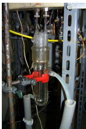
Figura 3.2. Esquema da unidade catalítica
