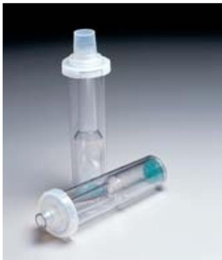
**Figura 4. 3: Ilustração do Centriprep<sup>®</sup>, utilizado para a concentração da proteína.**
