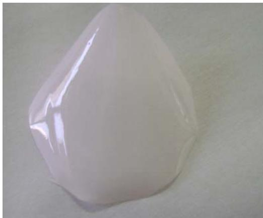
**Figura A.2. 4: Fotografia da membrana de PVA plastificada por PEG 300, razão mássica oligômero/polímero igual a 2.**
