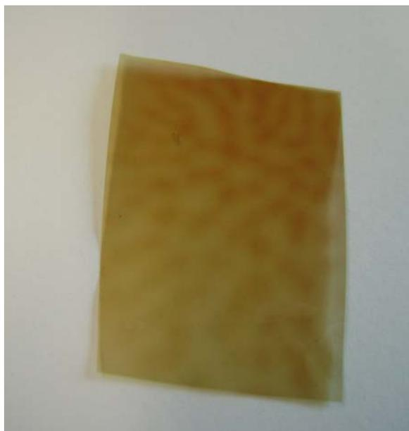
**Figura 4. 5:** Fotografia da membrana densa integral de alginato de sódio (Mb/alginato = 2 g/g).
