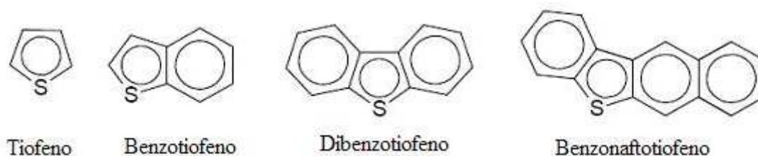
Figura 2.5 - Principais famílias de compostos sulfurados envolvidos nas reações de HDT (adaptada de SILVA, 2007).
