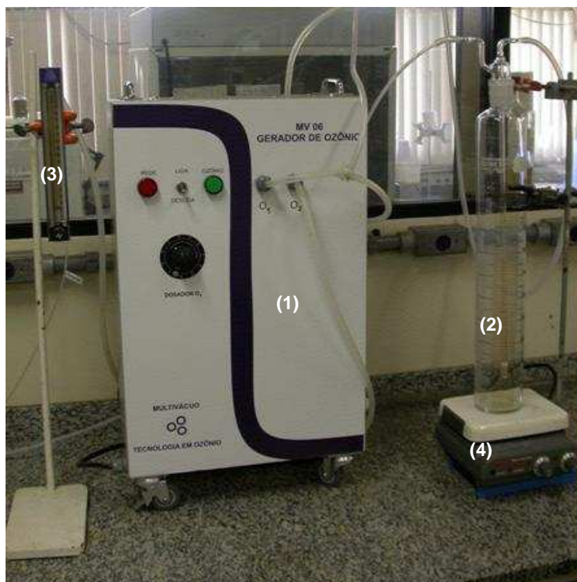
Figura 3.1. Sistema de ozonização do lodo biológico. (1) Gerador de ozônio; (2) Coluna de borbulhamento; (3) rotâmetro; (4) agitador magnético.
