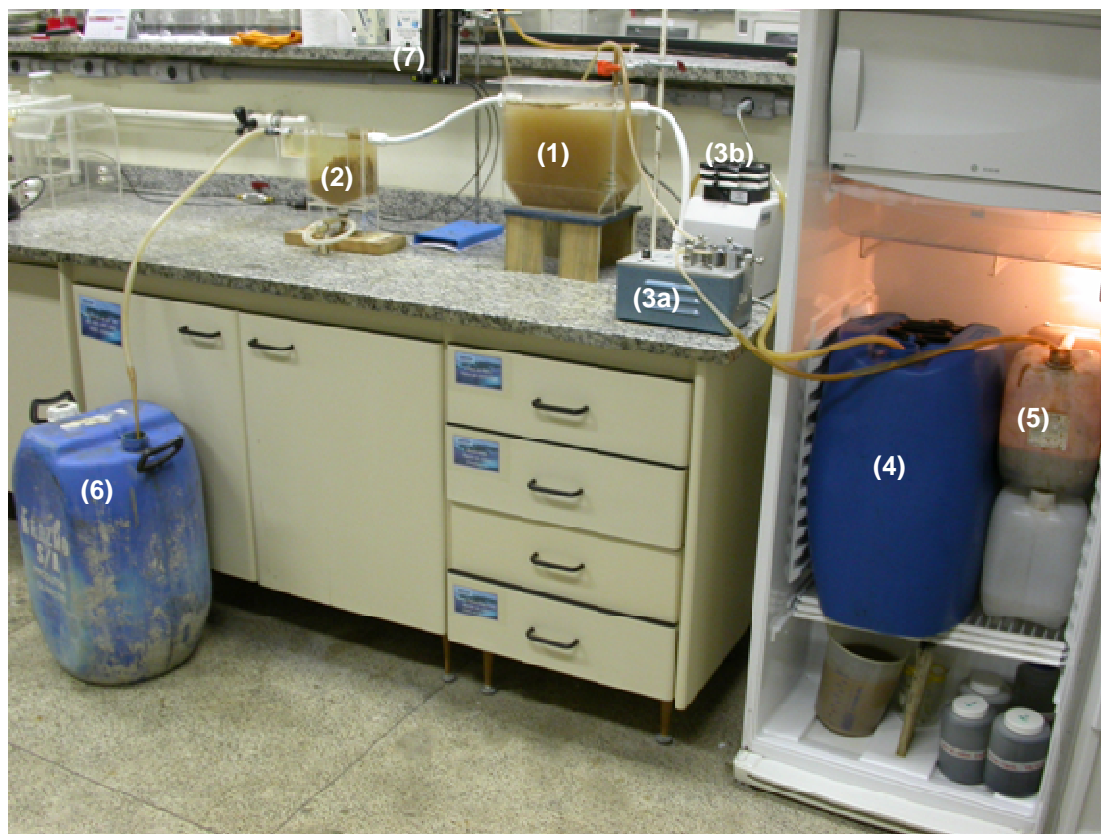
Figura 3.2. Sistema experimental usado nos ensaios de operação contínua. (1) reator biológico; (2) decantador secundário; (3a) bomba de lodo de reciclo e (3b) bomba de alimentação; (4) efluente de alimentação; (5) lodo de reciclo; (6) descarte do efluente clarificado; (7) rotâmetro.
