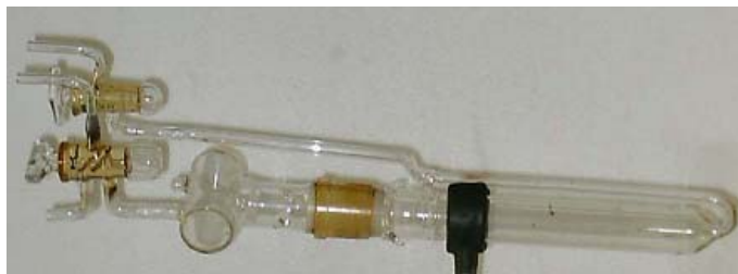
FIGURA 4.3: Célula de infravermelho utilizada nas análises de infravermelho in situ .
