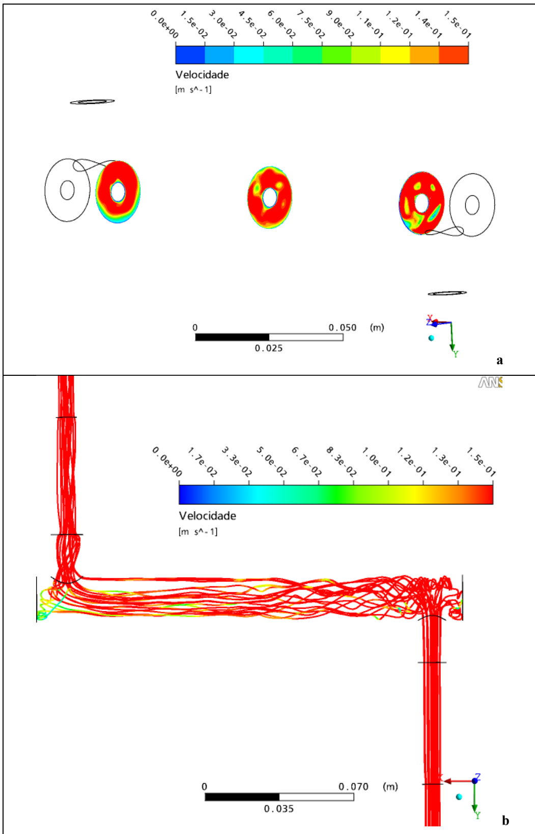
Figura 4.13: Perfil de velocidade para malha ML2. BSL e Reynolds igual a 3.000. (a) perfil de velocidade para três seções transversais ao escoamento e (b) perfil de velocidade representado por linhas de corrente.
