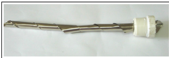
Figura 3.6: Folha de níquel em conformação espiralada com área de 112 cm 2 . Anodo do sistema eletrolítico.
