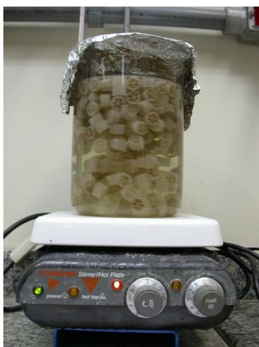
**Figura 4.8** – Unidade experimental para o estudo da desnitrificação.
