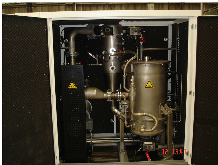
Figura 17. Sistema evaporativo piloto por destilação térmica da marca Loft.
