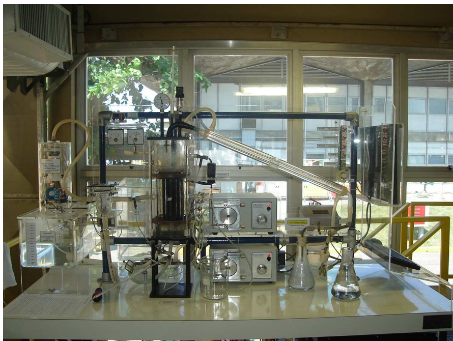
Figura 14. Figura do evaporador de simples efeito utilizado nos ensaios em escala de bancada.
