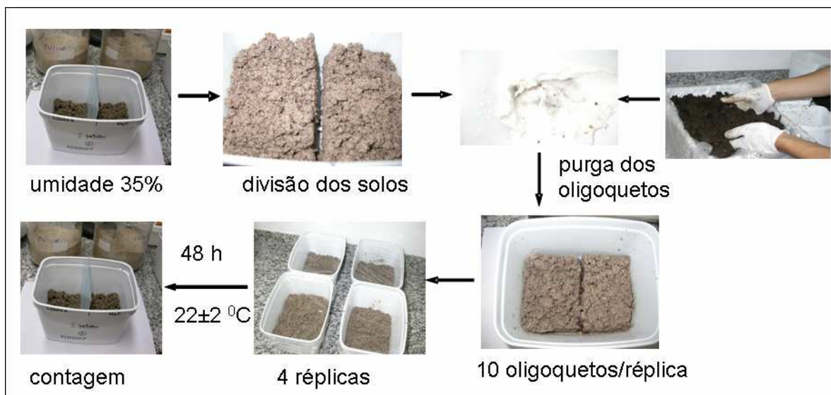
Figura 23. Esquema simplificado do bioensaio de comportamento dos oligoquetos adicionados na linha central de recipientes com um lado com solo irrigado com água destilada e o outro com solo irrigado com o produto destilado.
