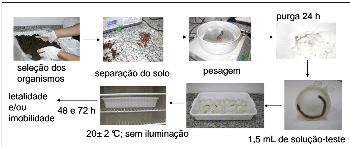
Figura 22. Ensaio de toxicidade aguda com oligoqueta Eisenia fetida em papel de contato.
