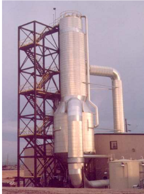
Figura 6: Sistema evaporador de tubos verticais tipo falling film com compressão mecânica de vapor (Heins & Peterson, 2005; Heins & Schooley, 2006; Heins et al. , 2005).
