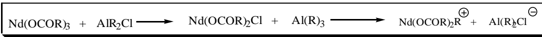
Figura 2.14a – Etapa de ativação de catalisadores a base de carboxilatos de metais de transição.
